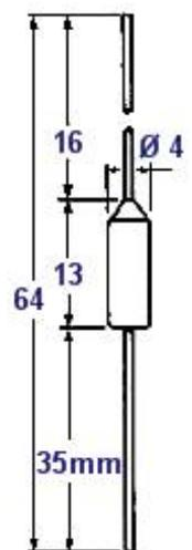
Temperaturwächter und -regler für selbsttätige Temperaturüberwachung und -regelung, zum Einsatz in elektrische Wärme- und Haushaltgeräte.
