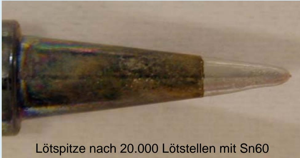
Lötspitze nach 20.000 Lötstellen mit Sn60
